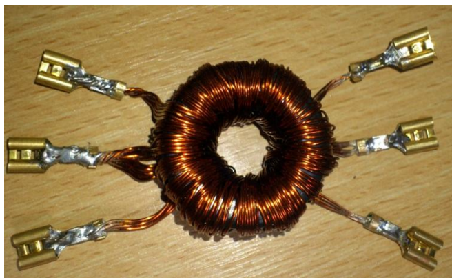
obr. G.1: Zhotovený transformátor
