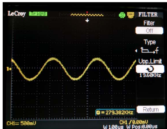
Gambar-1 Vout menunjukkan residu 1 Vpp PWM, diukur di output terminal dalam keadaan speaker terpasang
