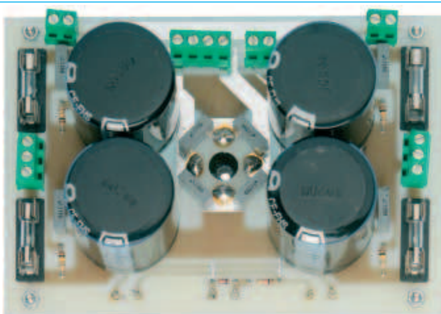
Fig.9 Fotografía del circuito impreso del alimentador LX.1649, vista por el lado de los componentes. Los cuatro fusibles están instalados en sus portafusibles (durante la verificación del valor de la tensión de salida no han de estar instalados).
