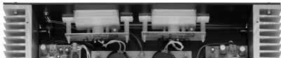
Fig.19 Detalle del montaje de los Vu-Meter LX.1115 (uno por cada canal) fijados al panel frontal del mueble con los separadores autoadhesivos.
